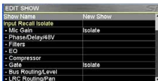
**EDIT SHOW – Global Recall Isolate** : empêche l'automation de rappeler des paramètres isolés (ou des groupes de paramètres) lorsqu'un Cue est affiché ; faites défiler jusqu'à l'élément souhaité, appuyez sur le codeur, puis sélectionnez Isolate (isoler).
