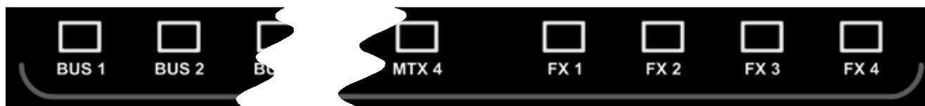
Ces touches mettent la console en mode MIX, permettant un mixage rapide et aisé des voies vers les bus, des voies vers les effets ou des bus vers la matrice. Le fait d'appuyer sur une touche déclenche une série d'évènements qui reconfigurent la surface de contrôle et le système d'écoute de la console, avec une organisation optimisée pour l'utilisation souhaitée ou requise.
