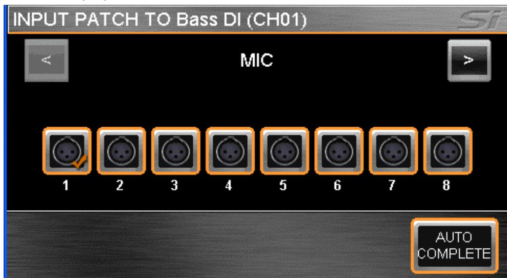
Pour que le système configure automatiquement plusieurs voies, appuyez sur le bouton AUTO COMPLETE ; ceci incrémente l'entrée de 1 et le Patch de 1 jusqu'à ce qu'un groupe logique de Patches soit complet. Pour quitter la configuration du PATCH, appuyer sur MENU, CUE LIST ou LEX.
