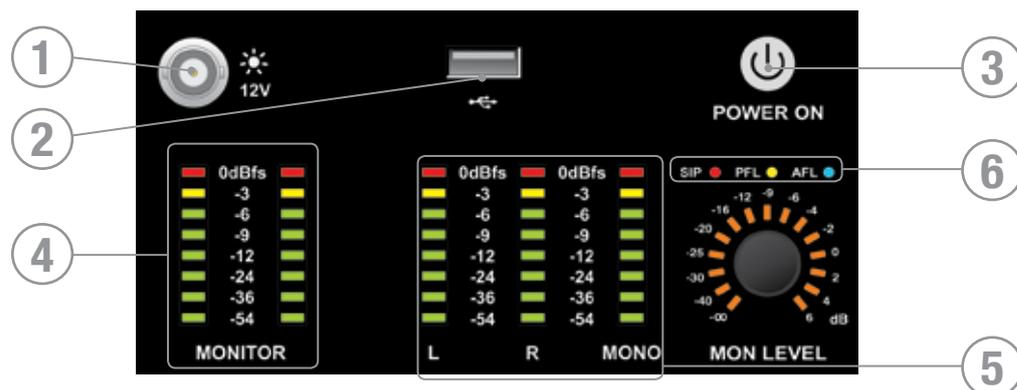
1. Sortie lampe 12V : connecteur pour lampe LED ou similaire pour console de mixage ; débit maximal en courant par embase BNC : 100 mA.
